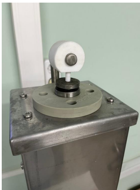
Рисунок 16. Изучение адгезионной прочности в нагружающей машине по патенту ОЭЗ «ВладМиВа».
